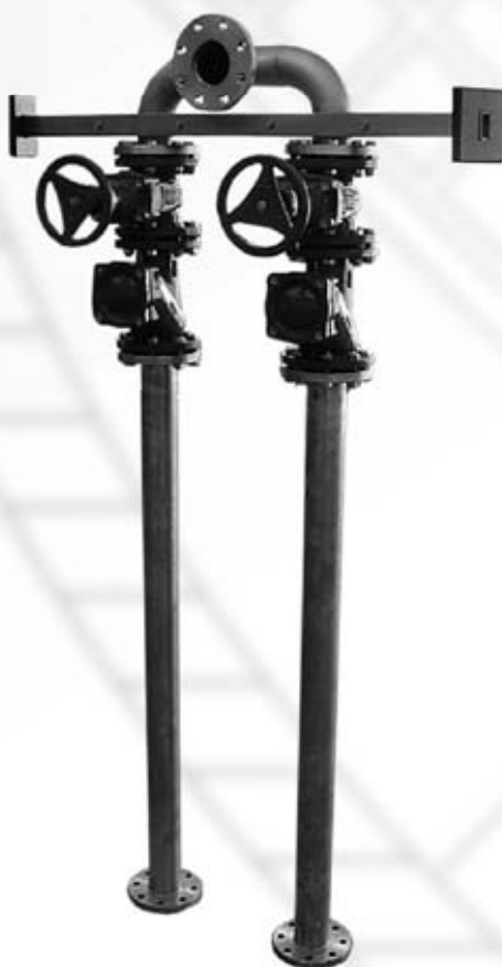
Pion tłoczny DN80 ze stali nierdzewnej, połączenia kołnierzowe z zaworem zwrotnym żeliwnym i zasuwą miękkouszczelnioną żeliwną.
