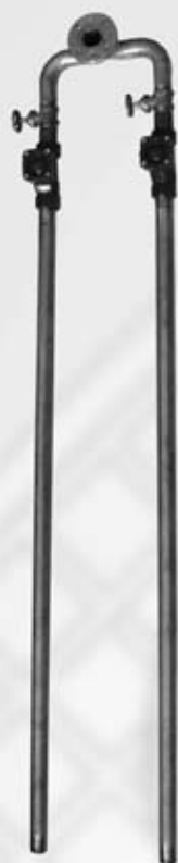
Pion tłoczny DN50 ze stali nierdzewnej, połączenia gwintowane z zaworem zwrotnym żeliwnym i zasuwą mosiężną.
