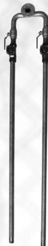
Pion tłoczny DN50 ze stali nierdzewnej, połączenia gwintowane z zaworem zwrotnym żeliwnym i zaworem odcinającym ze stali nierdzewnej.
